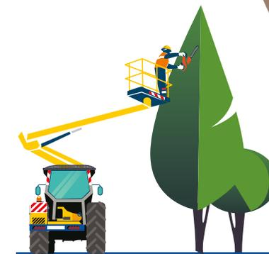
→ Au-delà d'une certaine hauteur et pour des interventions de taille nécessitant de la précision, il est nécessaire d'utiliser **une nacelle élvatrice**. Elle permet d'accéder rapidement et sans dangers en haut des arbres.
