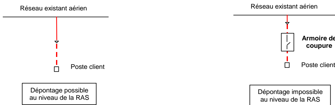
Figure 14 : Exemples de moyens de séparation d'un poste de livraison sur un réseau aérien
